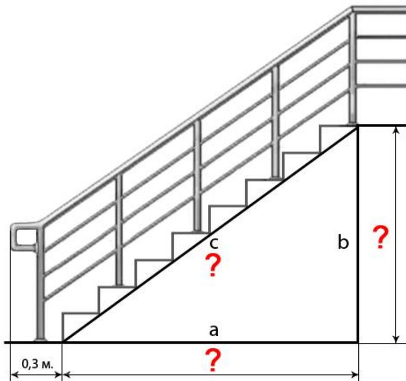
1. Замерьте длину марша в проекции на плоскости пола – размер  $a$ ;
